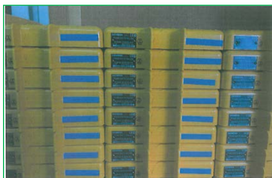
Foto 18: Fiecare baliza este apoi etichetata cu numarul sau/si pozitia sa fata de semnalul de circulatie.
