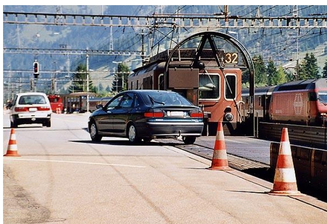
Figura 3 - Exemplu de vagoane pentru transportul autoturismelor, cu îmbarcare laterală
