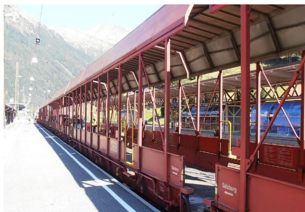
Figura 3 - Exemplu de vagoane pentru transportul autoturismelor, cu îmbarcare laterală
