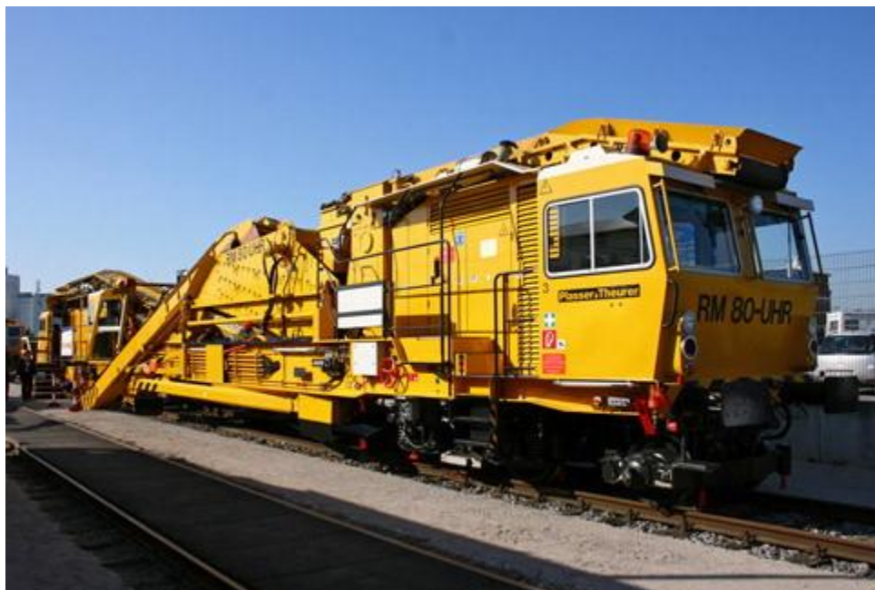
Figura 5 - Exemplu de mașină curățat balastul căii
