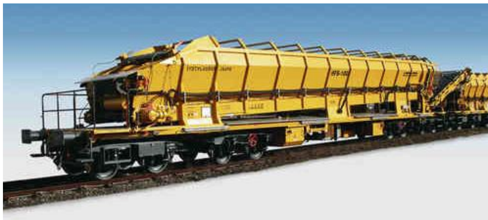
Figura 7 - Exemplu de vagon specializat pentru transportul materialului rezultat în urma ciuririi balastului căii
