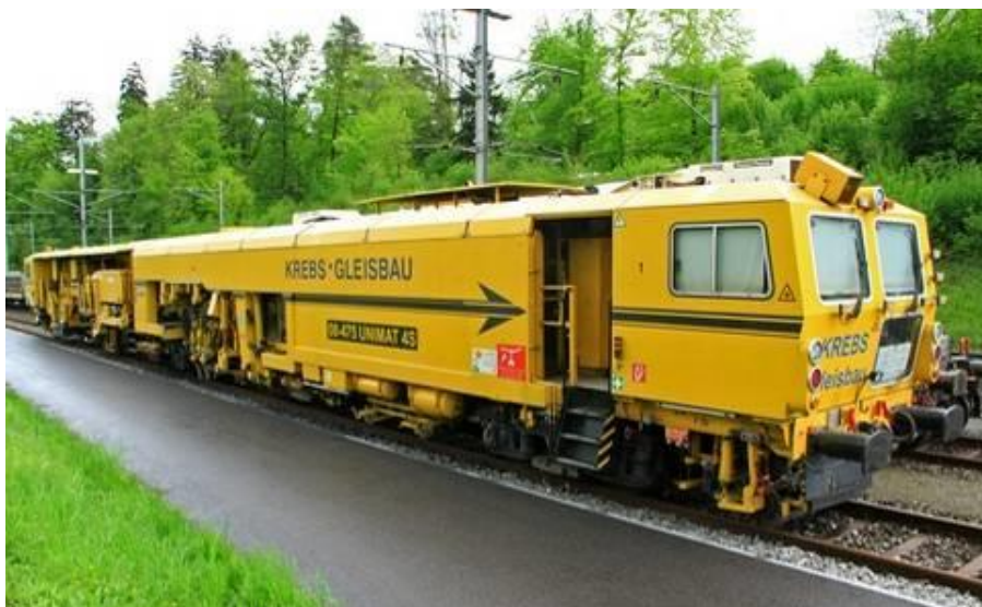
Figura 4 - Exemplu de mașină universală de burat linia și aparate de cale, cu avans continuu
