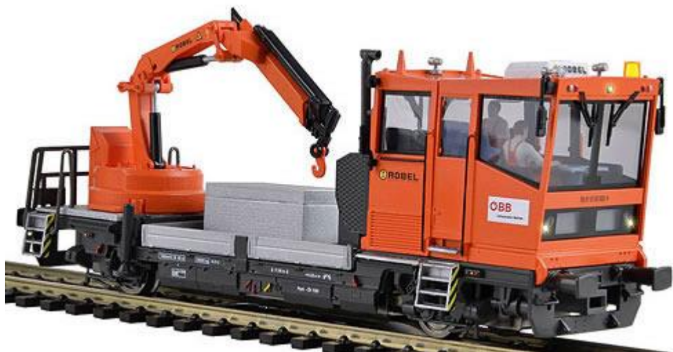
Figura 9 - Exemplu de drezină grea, multifuncțională
