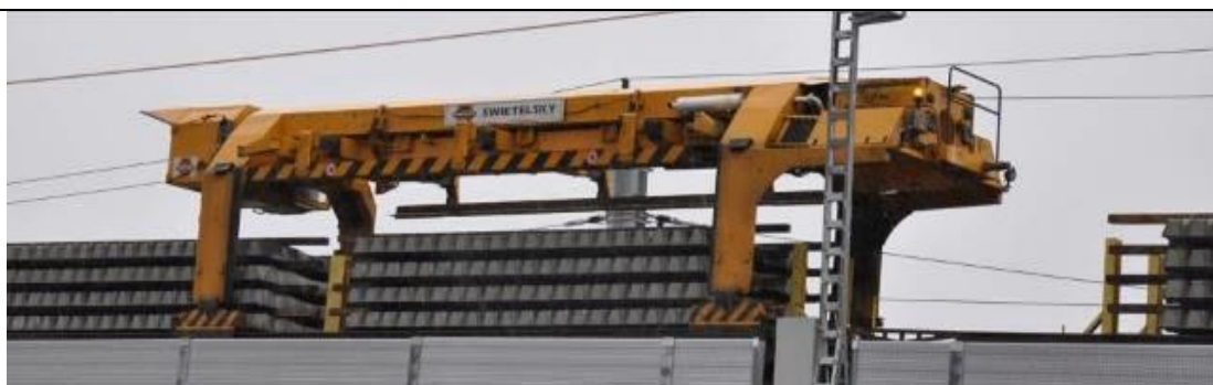
e) manipularea traverselor cu unitatea portal specializată
