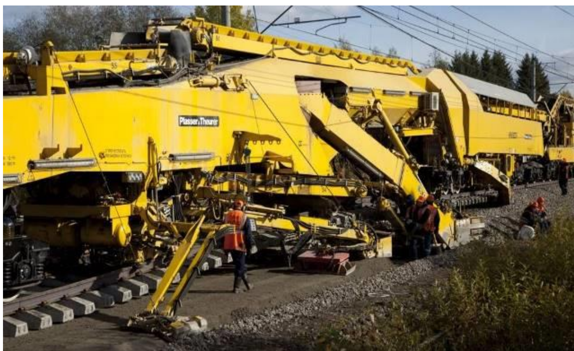
Figura 3 - Exemplu de tren de lucru pentru refacerea substratului căii
