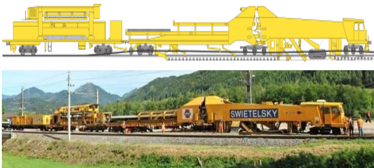
Figura 1 - Exemplu de de tren de lucru de mare productivitate pentru refacția căii
