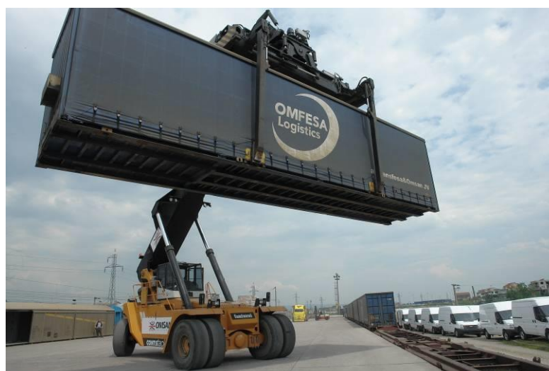
Figura 11 - Exemplu de utilaj pe pneuri de tip motostivitor pentru manipularea containerelor
