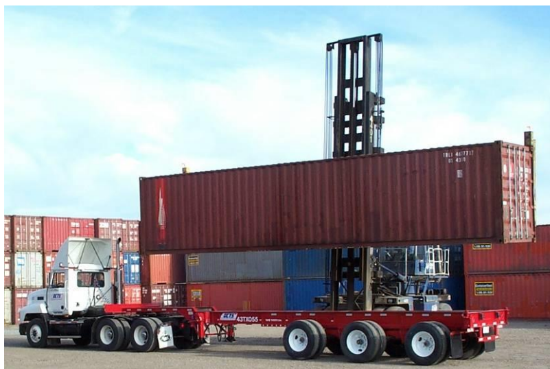
Figura 11 - Exemplu de utilaj pe pneuri de tip motostivitor pentru manipularea containerelor
