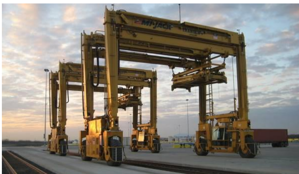
Figura 13 - Exemple de macarale portal pentru manipularea containerelor a) Pe șine b) Pe pneuri
