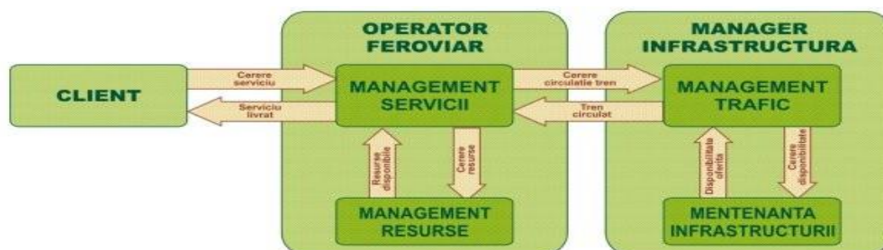
S4 Figura 3. Diagrama funcțională de principiu a serviciului de transport feroviar
